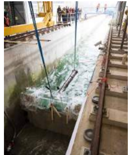
In de Deltagoot worden voortdurend slimme oplossingen getest: proefopstelling met heftige golfslag.
